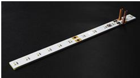
集電スプリングとネジを基板に組み付けた完成イメージ
